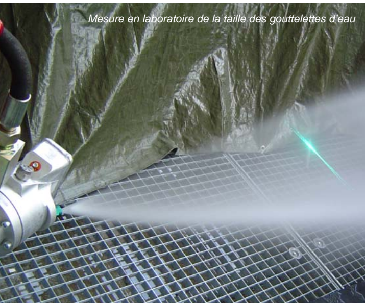
Production de neige dans la chambre froide du ITFE à Windisch
