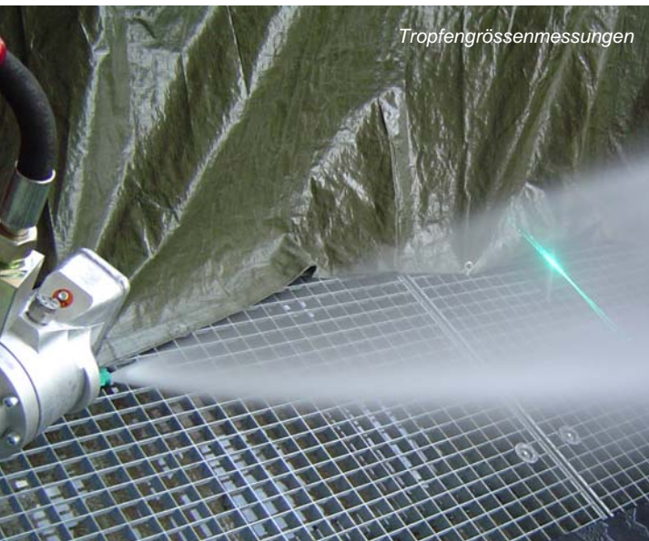
Schneien im Klimawindkanal der FHNW in Windisch
